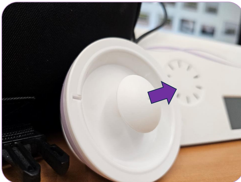
3. ábra Talp cseréje a vizsgálófejben
